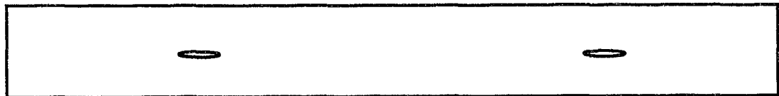
Пример 2 - две несплошности длиной по 6,4 мм
