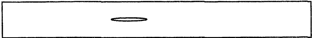
Пример 1 - одна несплошность длиной 12,7 мм
