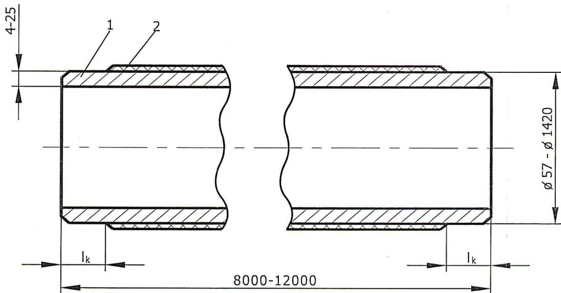
1 – труба; 2 – наружное полиэтиленовое покрытие
