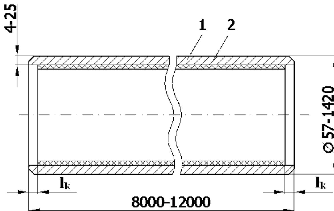
1 – труба, 2 – внутреннее эпоксидное покрытие по всей поверхности за исключением концевых участков  $l_k$ ;  $l_k = 40 \pm 10$  мм для труб диаметром 57-426 мм;  $l_k = 70 \pm 10$  мм для труб диаметром 530-1420 мм.
